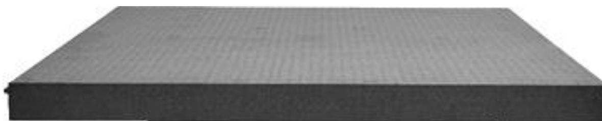
*Les panneaux isolants blaugelb **MultiPro** sont pourvus d'un assemblage à rainure et languette sur 2 côtés de sorte que les bandes sciées peuvent être facilement allongées.*
